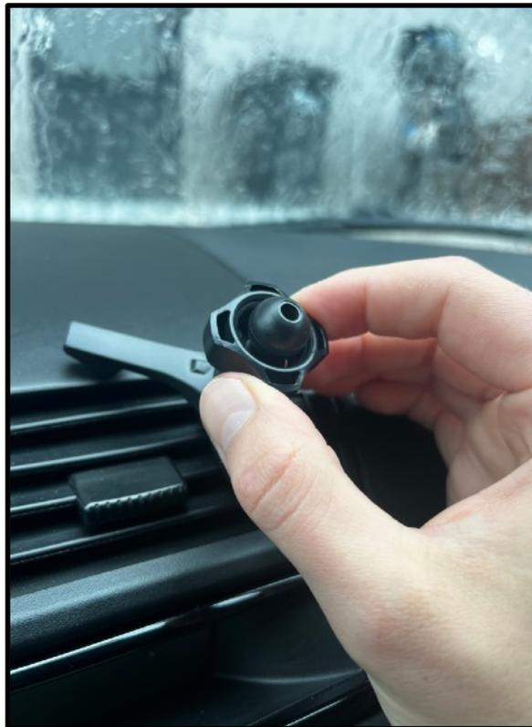
6. Deslice la parte posterior del cargador en la tuerca de plástico y, a continuación, enrosque la tuerca hasta que la conexión quede ajustada.
